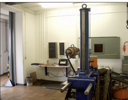
Und in diesem Strahlenschutzraum an der SLV Mannheim werden z.B. Autofelgen geröntgt, um für das Auge verborgene Risse zu erkennen.
